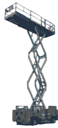
PEMP dont la translation avec la plate-forme de travail en position haute ne peut être commandée que par un organe situé sur la plate-forme de travail avec élévation suivant un axe vertical.
